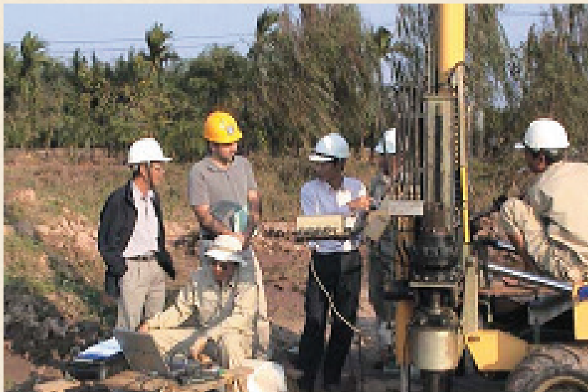
Thí nghiệm xuyên tĩnh công trình tuyến đường sắt đô thị Hà Nội năm 2009
