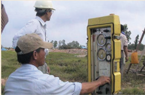
Thí nghiệm nén ngang công trình khách sạn 5 sao Dầu khí Mỹ Trì năm 2007
