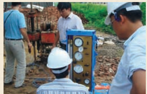
Thí nghiệm nén ngang công trình tàu điện ngầm Nhổn - ga Hà Nội năm 2011
